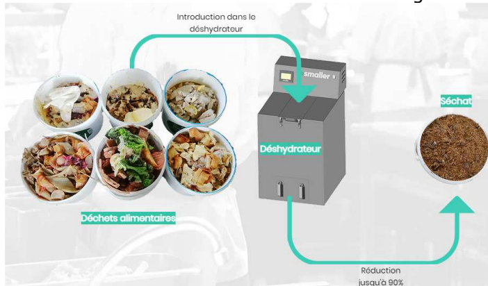
Fonctionnement du prétraitement avec un déshydrateur
